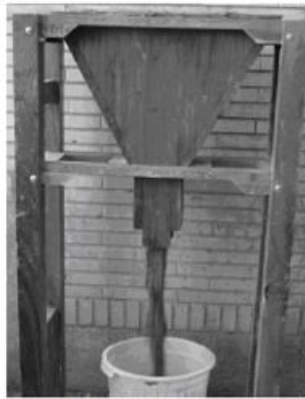
آزمایش فیال V-شکل بتن خودتراکم
